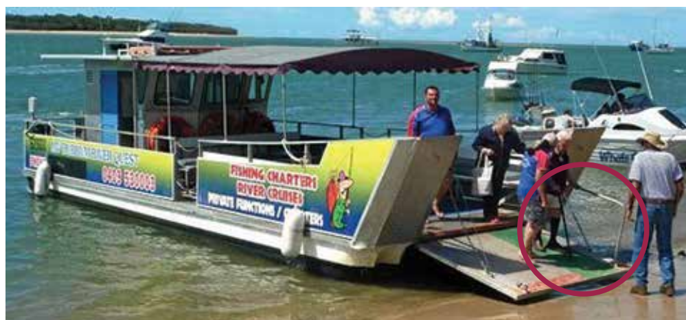
8. Dispositivo de transferencia: rampa con pasamanos Fuente: < https://bit.ly/2OXgdnj >
