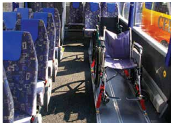
19. Espacio para persona usuaria de silla de ruedas 28. Sujeción para silla de ruedas Fuente: < https://bit.ly/2OQCNO5 >
