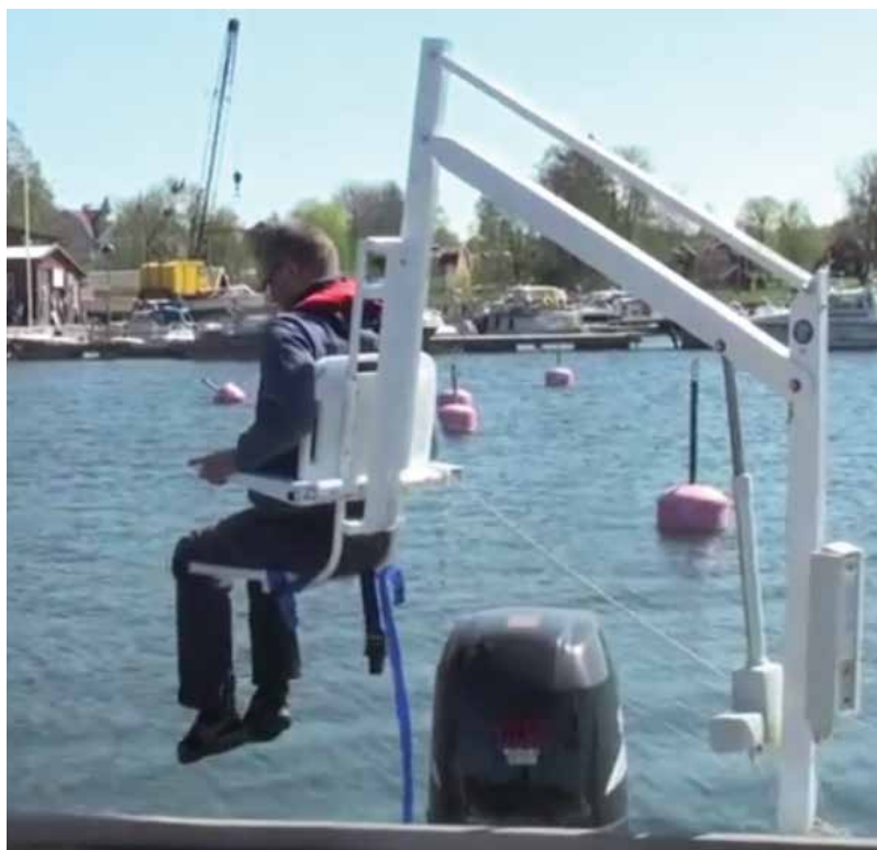
2. Dispositivo de transferencia: grúa en embarcación Fuente: < https://goo.gl/nPsPx2 >
