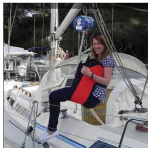
7. Dispositivo de transferencia: arnés para la transferencia con una grúa para el embarque Fuente: < https://bit.ly/2FoYipY >
