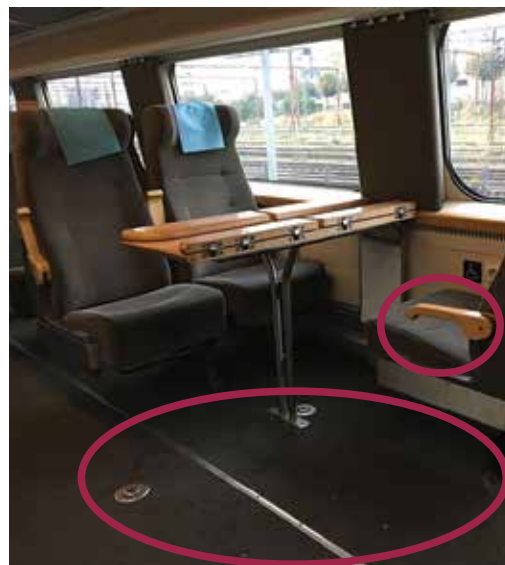
Derecha: 22. Descansa-brazos abatible y espacio para PSdR junto a acompañante Fuente: < https://bit.ly/2r1frMh >
