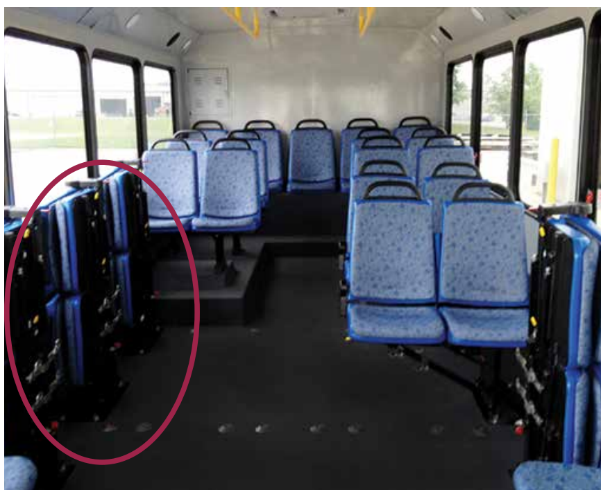
36. Asientos plegables y abatibles en el espacio para PSdR Fuente: < https://bit.ly/2PRO1HM >
