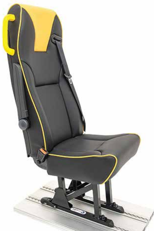
30. Asiento desmontable sobre rieles; para la sujeción de silla de ruedas
