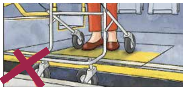
3. Brechas horizontal y vertical mayor a la permitida Fuente: BVG, 2018
