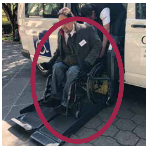
8. Plataforma elevadora Fuente: Janett Jiménez
