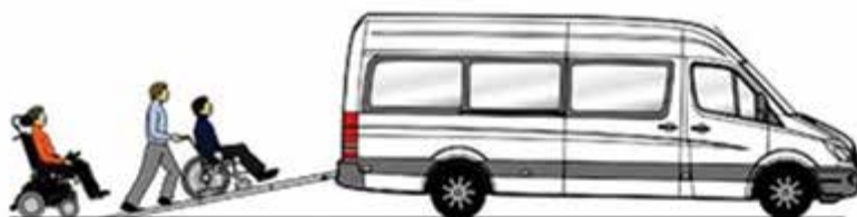
8 y 9. Dispositivos de transferencia 10. Acceso por puerta posterior Fuente: MasterBox SRL de CV
