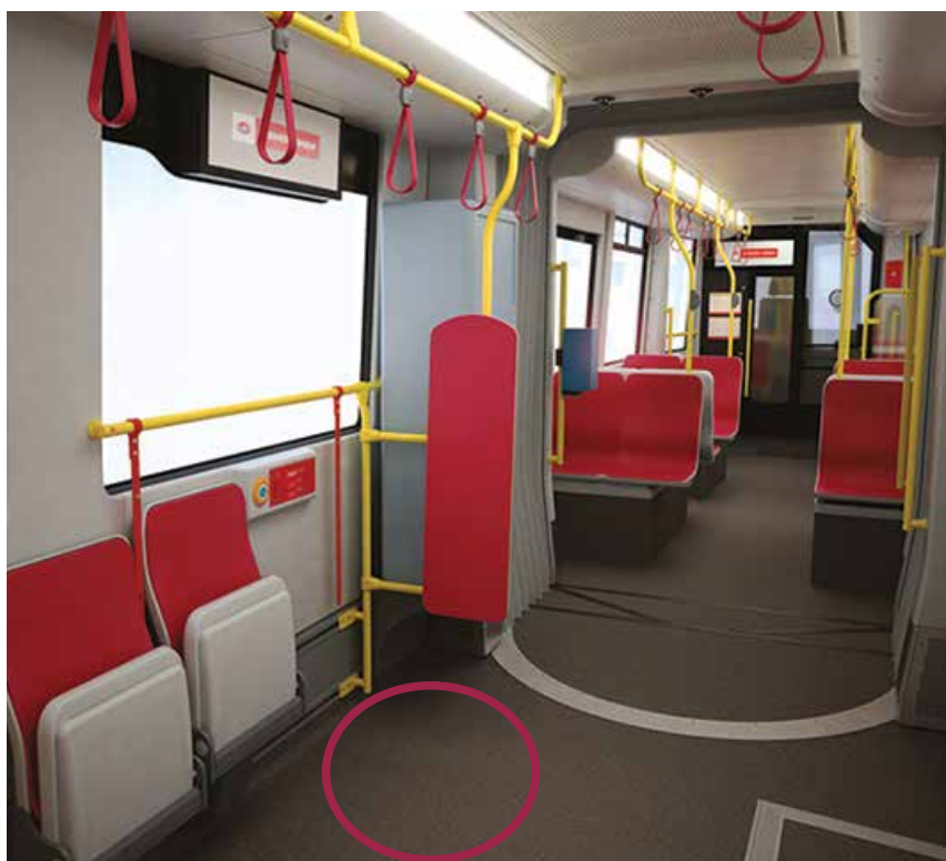
25 - 29. Espacio para persona usuaria de silla de ruedas 30 - 32. Botón de parada en el espacio para PSdR Fuente: < https://bit.ly/2DTZq36 >
