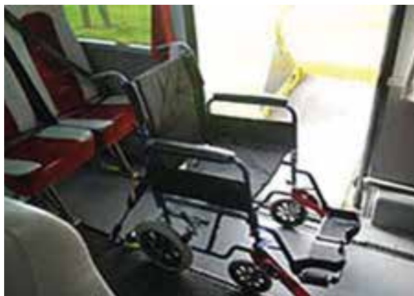
19. Espacio para persona usuaria de silla de ruedas 28. Sujeción y retención para PSdR Fuente: < https://bit.ly/2OQCNO5 >
